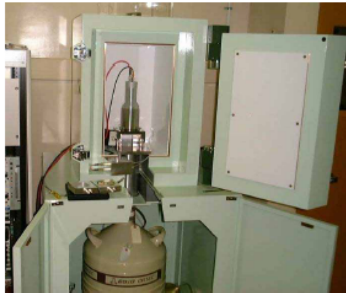
ゲルマニウム半導体検出器 で \gamma 線のエネルギーを測定
